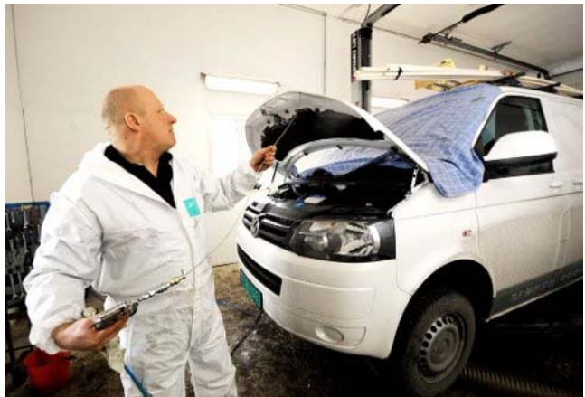
ALLE KANALAR: Bonde og mekanikar Hans Forberg behandlar både understell, panser, dører og alle kanalar i køyretyet. Den økologiske oljen trekkjer godt inn. Ein anbefalar ei ny behandling etter havtanna år. Foto: INGE FJELDDALEN
